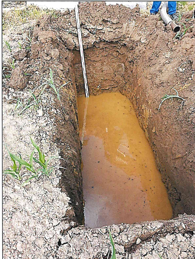
Wasserstand in der Sickergrube/ Schurf 2 nach dem Befüllen um 10:00 Uhr
