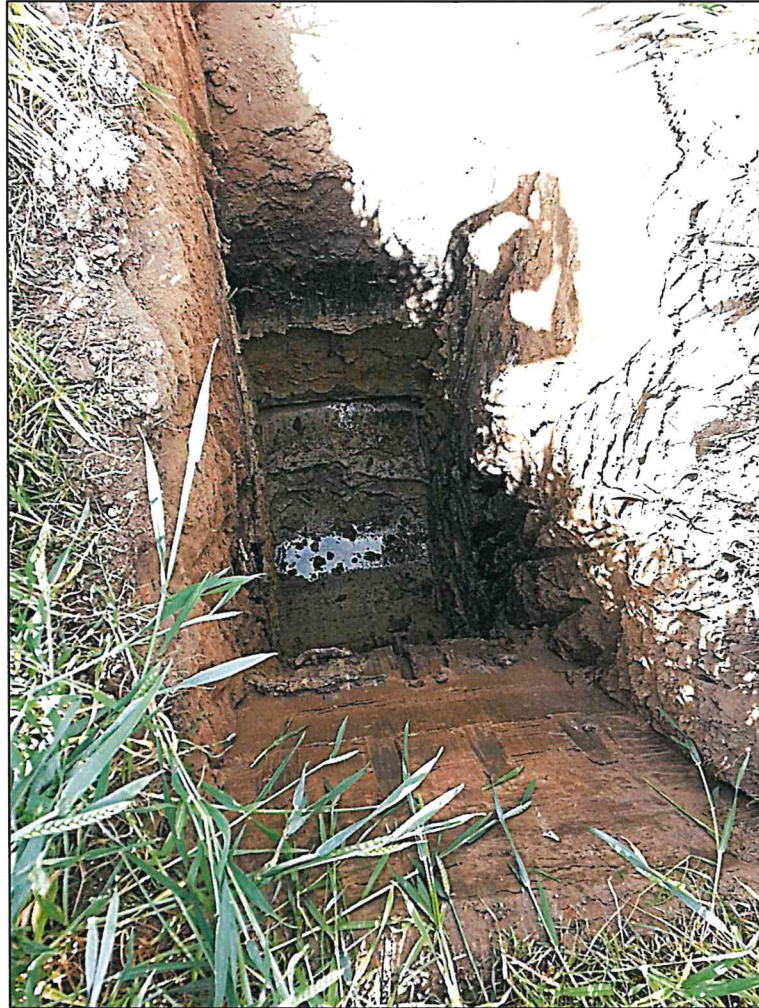
Schurf 1, Wasseransammlung ca. 60 Minuten nach Aushub
