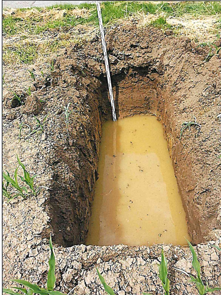
Wasserstand in der Sickergrube/ Schurf 2 nach 45 Minuten des Sickersversuchs
