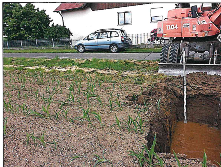
Wasserstand in der Sickergrube/ Schurf 2 zu Beginn des Sickersversuchs
